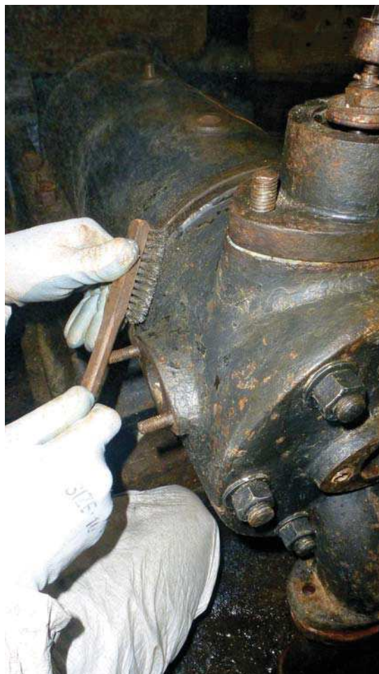
Fig. 3. Punta Linke. Asportazione della ruggine.
